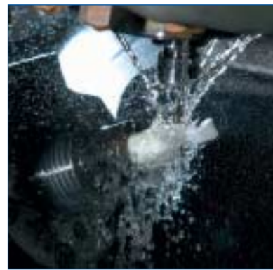
Werkstoff: geHPTes Zirkoniumdioxid in der fünfschichtigen Bearbeitung.
