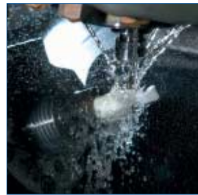
Werkstoff: geHPTes Zirkoniumdioxid in der fünfschichtigen Bearbeitung.
