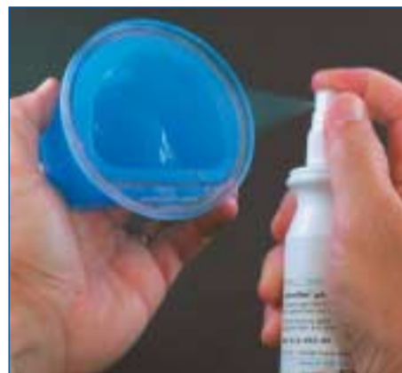
Abb. 2: Lubrofilm® Plus als Silikonentspannungsmittel für Dublierformen.
