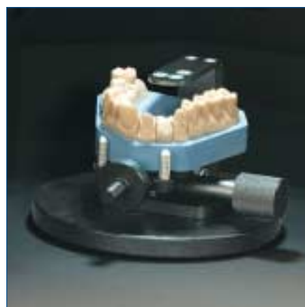
Mit Cercon eye können bis zu 16 Zahneinheiten gescannt und digitalisiert werden.
