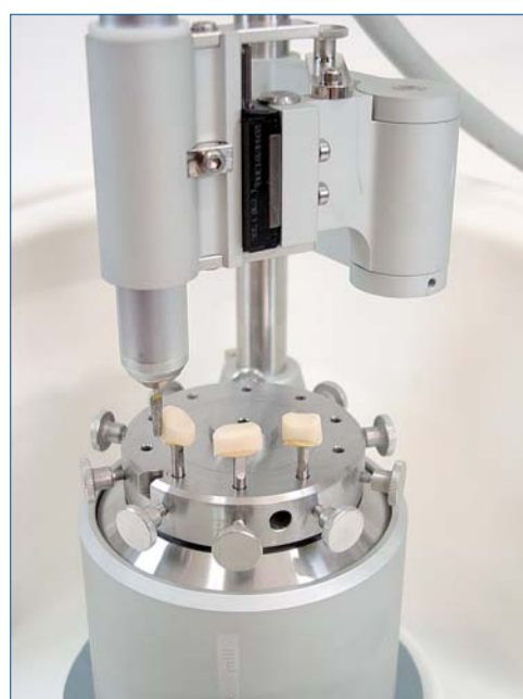
Da das neue Gerät ohne Elektronik auskommt, stellt die Kühlung mit Wasser beim Bearbeiten von Zirkoniumkappchen kein Sicherheitsrisiko mehr dar.
