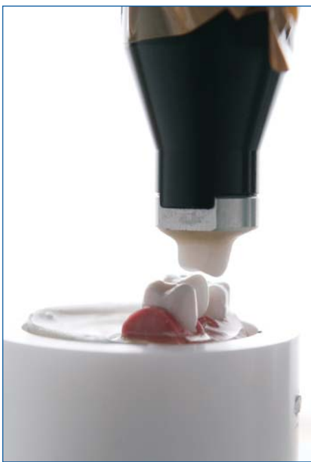
Aufbau für die Belastungsprüfung von zerion®.
