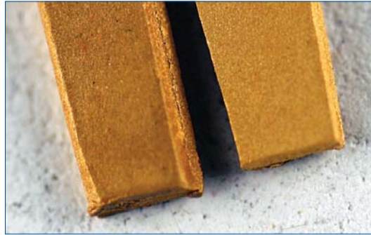
Das Oxid von Aztec (rechts) im direkten Vergleich mit einer in gleicher Weise behandelten Mitbewerber-Legierung.
