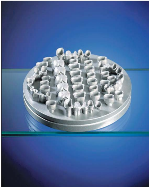
Abb. 1: Wirtschaftliche Fertigung von CrCoMo-Gerüsten mit Hint-ELs® rapidpro.
