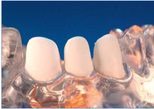
Elektrophoretisch abgeschiedene ECS-Vollkeramikgerüste.
