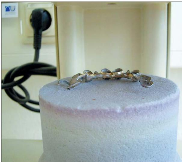
Abb. 16: Abgestrahltes Gussobjekt nach dem Entspannen.
