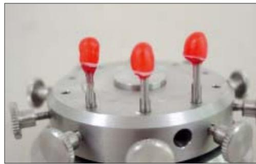
Abb. 11: Mit Pattern Resin werden die Sekundärteile modelliert.
