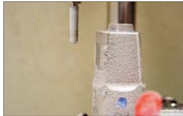
Abb. 13: Damit die Gummipolierer dem Winkel der Primärteile entsprechen, können sie am Abziehdiamanten immer wieder definiert abgezogen werden – das sorgt für gleichmäßig dünne Wandungen.
