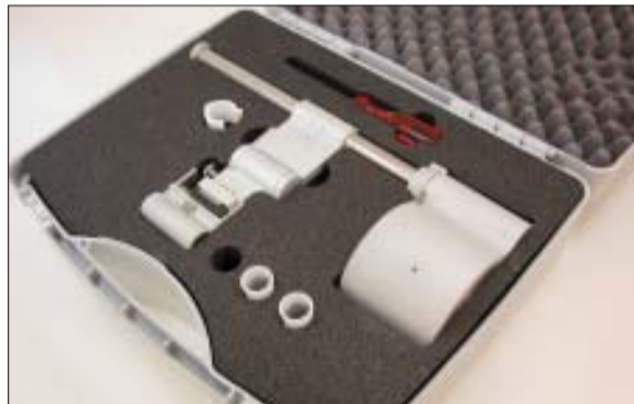
Abb. 7: Telemaster-mill kann über verschiedene Adapter mit den Turbinen aller gängigen Hersteller kombiniert werden. Arbeiten bei Nasskühlung macht dem Fräsgerät nichts aus. Neben Zeitvorteil und uneingeschränkter Beweglichkeit zeigt sich gerade beim Nassschleifen der große Vorteil gegenüber Gipssockeln.
