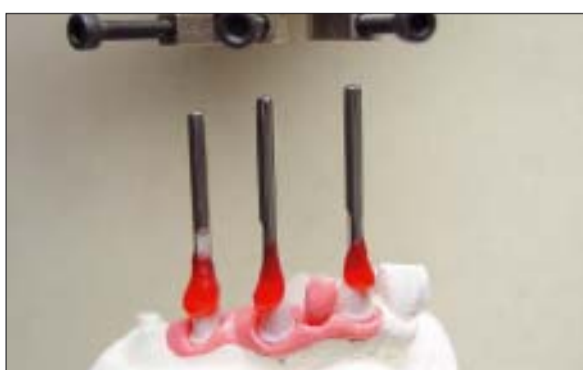
Abb. 5: Kein Verkannten: Löst man die Verbindungsschrauben der Schwenkarme, bleiben die Primärteile beim Hochziehen des Bohrfutters mit den Pins auf dem Modell zurück – auch bei divergierenden Stumpfachsen.
