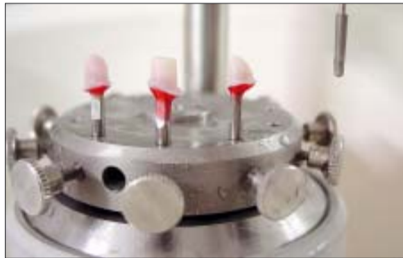
Abb. 8: Arbeiten bei Nasskühlung macht dem Fräsgerät nichts aus. Neben Zeitvorteil und uneingeschränkter Beweglichkeit zeigt sich gerade beim Nassschleifen der große Vorteil gegenüber Gipssockeln.
