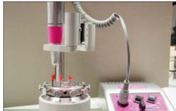
Abb. 12: Die Kunststoffkappchen werden mit einer geeigneten Technikmaschine bearbeitet. Über Adapter kann Telemaster-mill mit den Technikmaschinen aller gängigen Hersteller kombiniert werden.
