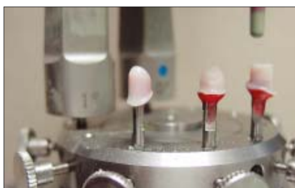
Abb. 10: Nur mit Gummi: Die Primärteile werden auch hochglanzpoliert. Damit sie den 1°-Winkel behalten, hat der Telemaster Abziehsteine mit definierten Winkeln.
