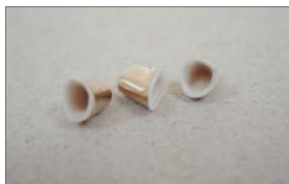
Abb. 15: Präzise und leicht: Die gegossenen Sekundärteile sind gleichmäßig dünn und wiegen zusammen nur 1,3 Gramm.
