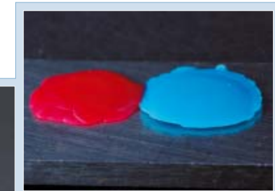
Kontraktionsverhalten ▶ StarWax C (rot) und Fremdwachs (blau).
