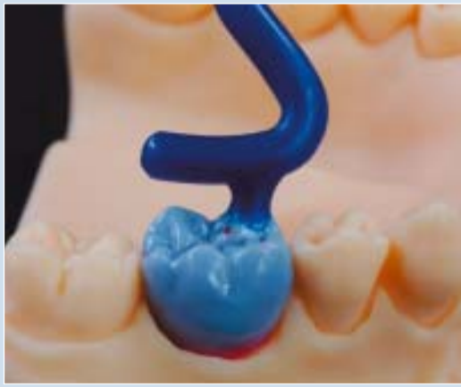
Gusskanalanlage bei Einzelkronen ▲ Beste Gussqualität bei indirekter Zuführung.
