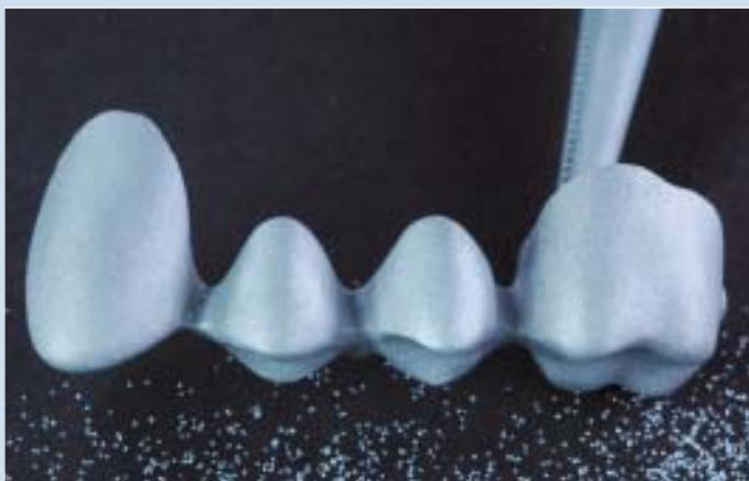
◀ Strahlen mit Aluminiumoxid Korngröße 125 µm und niedrigem Strahldruck (ca. 2 bis 3 bar).
