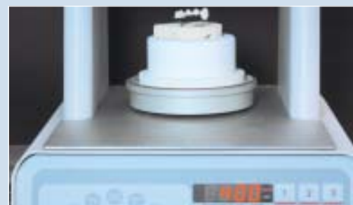
Opakerbrand ▲ Brennprogramme an den verwendeten Ofentyp anpassen.
