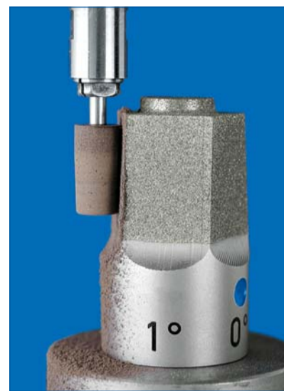
Herstellen des gewünschten Winkels: Den Polierer mit der Mantelfläche auf der entsprechenden diamantierten Schräge (hier: 2°) auf dem Block leicht kreisend abrichten.
