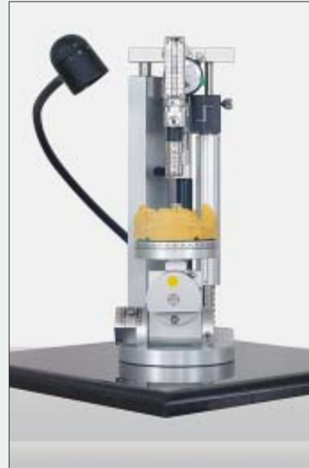
Für eine gelungene Implantatprothetik: Auf dem Achsentisch vermisst der Techniker das Modell genau und schlägt aus statischer, prothetischer Sicht die günstigsten Implantatpositionen vor. Diese dienen in der Impla 3D-Software als Ausgangspunkt für die weitere Planung. (Foto: Schütz Dental, Rosbach)
