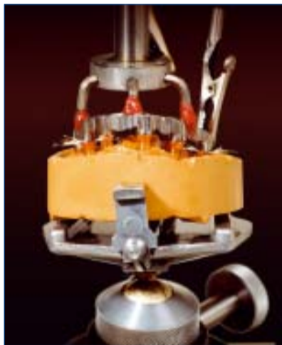
Funkenerosionsprozess mit Kupferelektroden.
