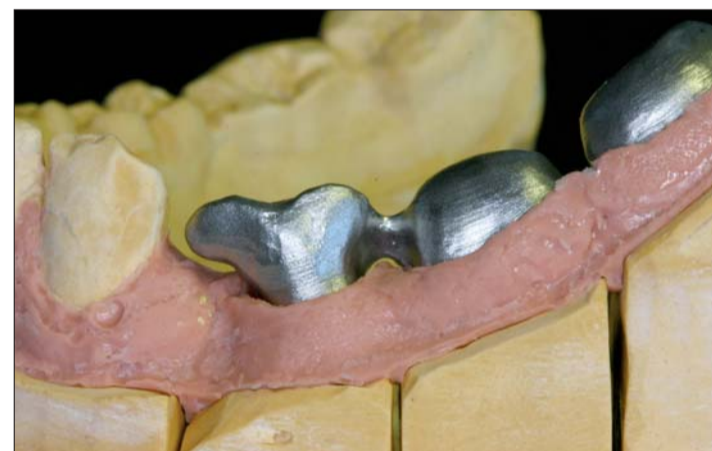
Abb. 6: Gut gegossen – Gussergebnis und Randschluss des Wirobond 280-Gerüsts sind einwandfrei.
