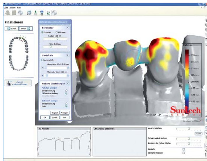
Mit dem virtuellen Wachsmesser können die Konstruktionsvorschläge der Software einfach, schnell und punktgenau bearbeitet werden.
