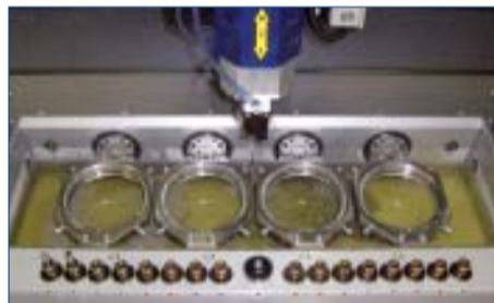
Vier Blankhalter für unterschiedliche Blankstärken garantieren eine rationelle und wirtschaftliche Arbeitsweise in größeren Laboren und Fräszentren.
