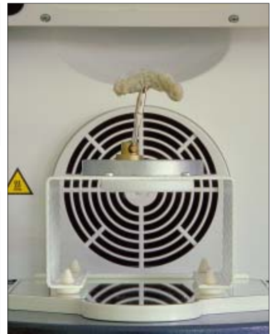
Abb. 42: Die Polymerisation findet im Lumamat 100 in einem kombinierten Licht-Hitze-Zyklus statt.
