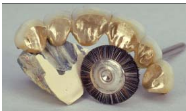
Abb. 57: Die Politur der Goldanteile erfolgt mit einer weichen Robinsonbürste und einer relativ aggressiven Polierpaste.
