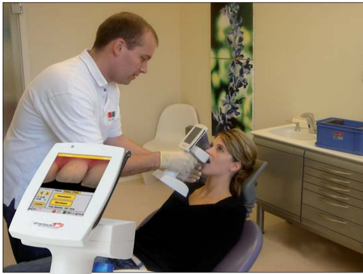
ZTM Andreas Campregher aus dem Labor Mandel, Frankenthal, bestimmt bei einer seiner Patientinnen die Zahnfarbe mithilfe des Shadepilots. Foto: Labor Mandel
