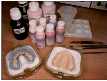
Abb. 18: Zum Stopfen verwenden wir Heiß- oder Kalt-Polymerisat von Candulor, das wir mit Aesthetic Intensive Color individualisieren.
