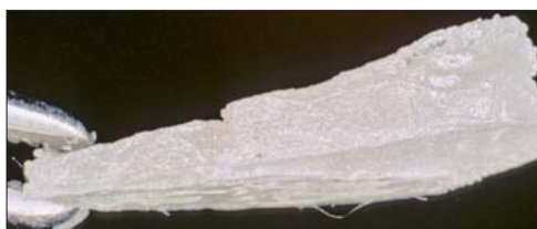
Abb. 5: Schlechtes Brandergebnis mit Wasser.
