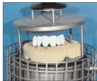
Abb. 8 und 9: Die Objekte werden auf dem Brenngutträger in der Trocknungskammer des Heißluftgerätes bis zur vollständigen Trocknung belassen.
