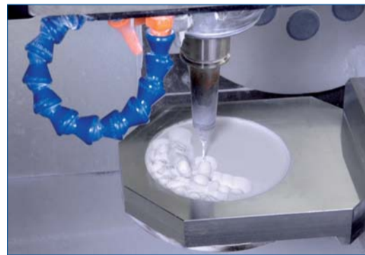
Beim Fräsvorgang kommen hochmoderne Fünf-Achs-HSC-Fräsmaschinen zum Einsatz.
