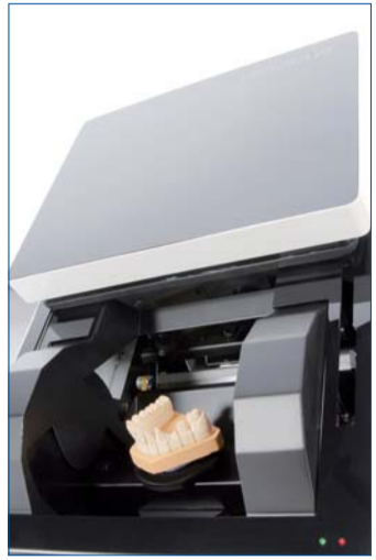
Zu Beginn wird das Gipsmodell mithilfe des 3-D-Scanners 3Shape in ein virtuelles Modell umgewandelt.
