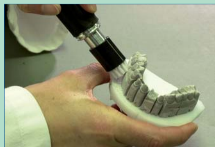
Der Feinstaub am Modell gehört zu den täglichen kleinen Ärgernissen im Labor. Mit dem AIRPRO kann er nun schnell und punktgenau entfernt werden.
