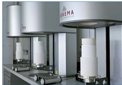
Die einzelnen Sinteröfen sind gemeinsam an eine Netzwerksteuerung angeschlossen und können dadurch effektiv arbeiten.
