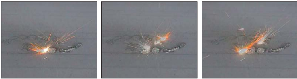
Das SLM-Verfahren: Pulver auftragen, aufschmelzen, erstarren lassen – in der Belichtungsstrategie liegt dabei eines der wesentlichen Geheimnisse für die Herstellung passgenauer NEM-Gerüste.
