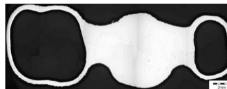
Nach dem Ätzen sieht man eine homogene Oberfläche des Gerüsts aus NEM (StarLoy LS, DeguDent, Hanau).
