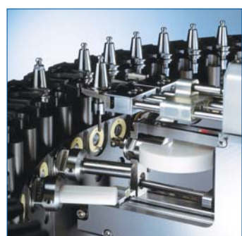
Die Fertigungsanlage Hint-ELs® dmmx verfügt über 31 Werkzeug- und 30 Werkstückplätze.
