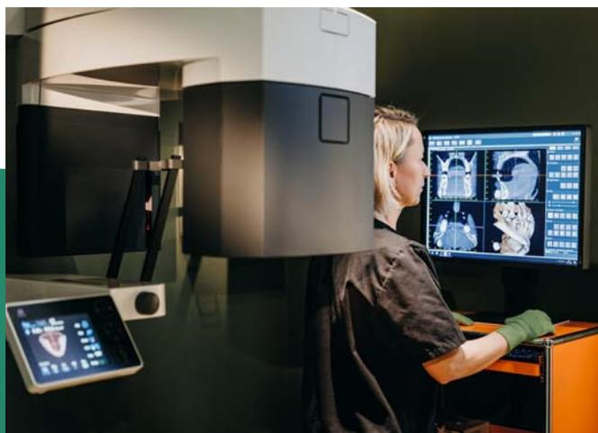
RadiForce MX216-SB im Einsatz mit DVT-Röntgengerät im abgedunkelten Raum (Raumklasse V)
