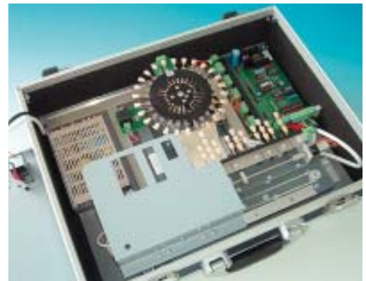
Innenansicht der Toothguide Training Box mit Vorlagenrad und verschiebbarem Toothguide.
