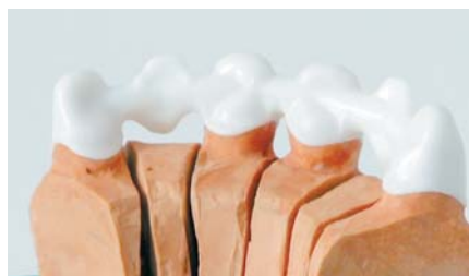
Unverblendetes Brückengerüst aus Zirkonoxidkeramik. (Everest-System, Foto: KaVo)
