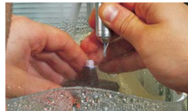
Wassergekühltes Schleifen im Fräsgerät.
