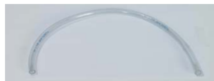
Abb. 4: Derselbe Schlauch nach WEK-Installation und Durchspülen mit GREEN&CLEAN WK.
