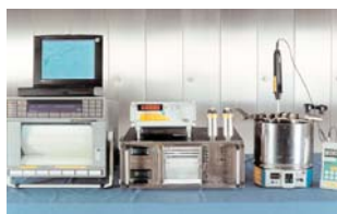
So aufwändig ist eine Validierungsanordnung nach EN 554.
