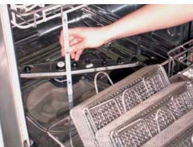
Wassermengenregelung mit einem Zentimetermaß.
