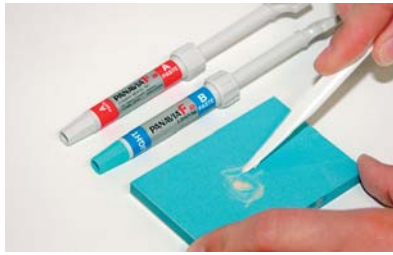
Abb. 12: Mischen der Komponenten A und B in gerade nur der benötigten Menge ohne Abfall und viel Überschuss.
