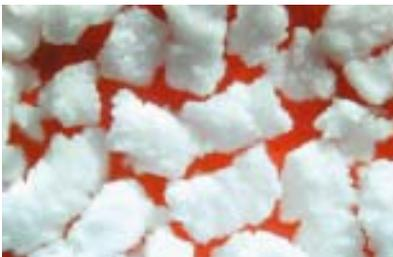
Abb. 1: Makrostruktur des porösen Materials PORE-SORB.
