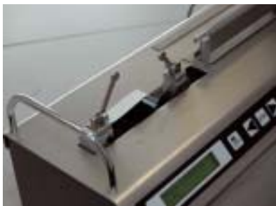
Abb. 1: Mit dem MELAG Folienschweißgerät MELAG-seal können Instrumente sicher eingeschweißt und so vor Kontamination geschützt gelagert werden.
