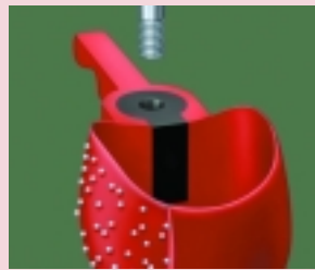
Abb. 3: Der Gewindestift wird in den Platzhalter eingeschraubt.
