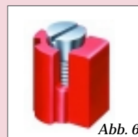
Abb. 6: Auslieferungszustand: Maße: Höhe 2,9 mm Breite: 2,7 mm Abb. 7: Beim Eindrehen der Schraube entsteht ein Dübeleffekt und somit ein sicherer Halt des Friktionsteiles. Abb. 8: Wird die Schraube weiter eingedreht, beginnt die stufenlose Friktionseinstellung.
