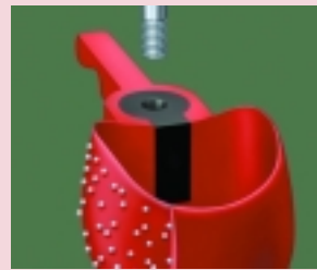
Abb. 3: Der Gewindestift wird in den Platzhalter eingeschraubt.
