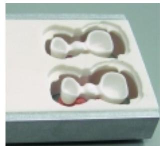
Abb. 2: DC-Leolux®-Rohling mit zwei gefrästen Brücken.
