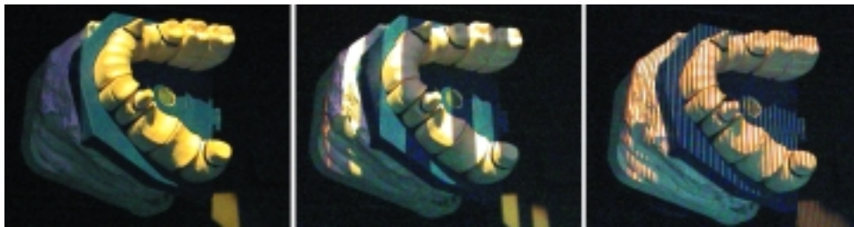
Abb. 1: Digiscan von Girrbach: Wechselnde Schattenstreifen-Projektion mit Weißlicht ermöglicht kurze Lesezeit bei hoher Präzision (Bildquelle: Archiv/Girrbach).
