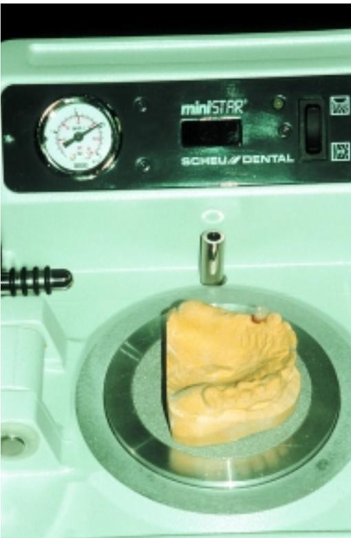
Abb. 5: Das Modell wird auf die Modellstützplatte gestellt.
