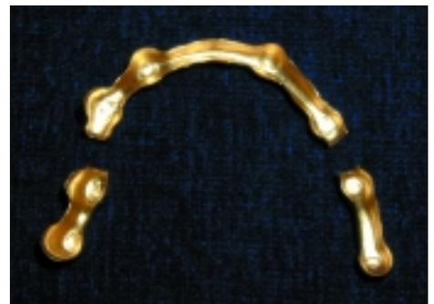
Abb. 5: Hülse dreigeteilt. Auf ein eingalvanisieren der Riegel wurde verzichtet, da die Fassung nach Basal zu schwach ausgefallen wären.
