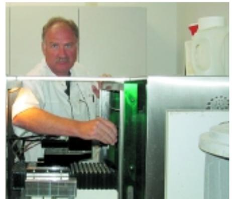
*Einspannen eines Rohlings in die DCS-Fräsmaschine.*
