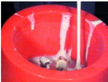
Abb. 5: Nach der Modellierung wird das Wachs eingebettet, ausgebrannt und gepresst. Vorsicht: Eine Abweichung von den Herstelleranweisungen kann zu Fehlpressungen oder Muffelbruch führen.
