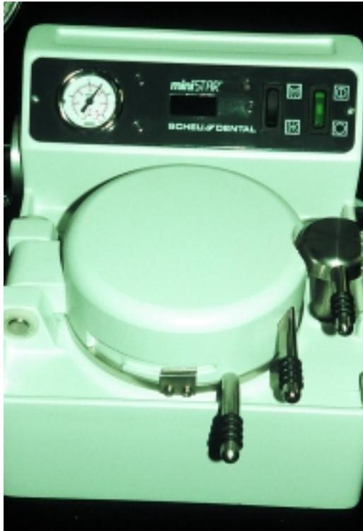
Abb. 7: Sobald die Schiene entsprechend der Vorheizzeit beheizt ist, wird der Druckbehälter geschlossen, und der Druck baut sich auf. Wiederum startet die Stoppuhr und zählt die Sekunden der Abkühlphase.
