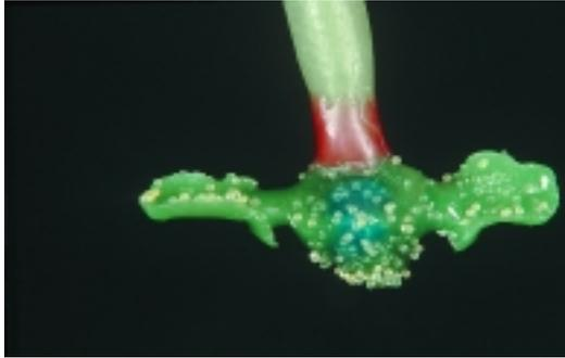
Abb. 3: Ein Gusskanal wird angewachst.
