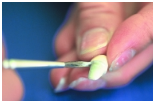
Abb. 6: Sorgfältiges Auftragen des Silberleitlacks ermöglicht beste Ergebnisse.
