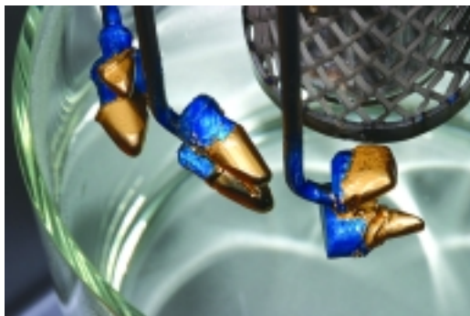
Abb. 24: Der Spülgang wird automatisch nach Abschluss der Galvanisierung durchgeführt.
