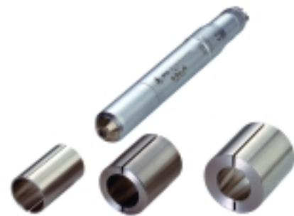
Abb. 18: Die Ausarbeitung erfolgt mittels Spezialturbine im Fräsgerät.
