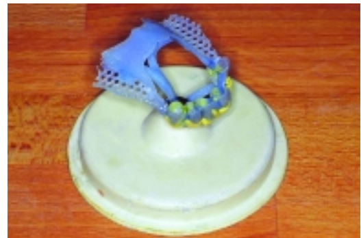
Abb. 14: Die Gusskanäle werden aus dem gleichen Material hergestellt. Nach dem Abheben und Festwachsen kann die Modellation überbettet werden.
