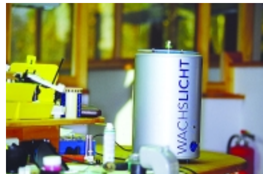
Abb. 10: Ein spezielles Lichthärtegerät härtet die gesamte Modellation spannungsfrei aus.
