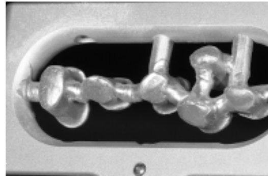
Abb. 16: Die Modellation wird im Spannrahmen fixiert, mit Silberpuder gepudert und im cercon brain gefräst.
