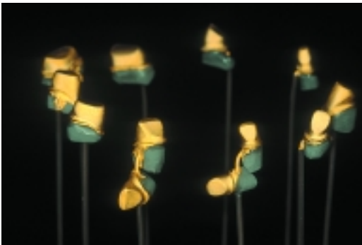
Abb. 13: Die galvanischen Abscheidungen mit dem HELIOFORM®-Gerät sind von bester Oberflächengüte.
