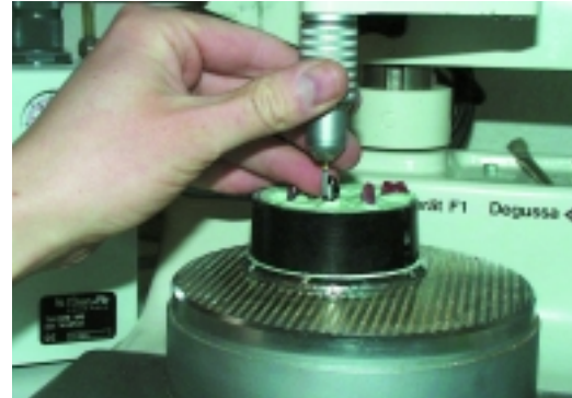
Abb. 10: Gut zu erkennen: weiße Fräsfläche auf schwarz lackiertem Zirkon.
