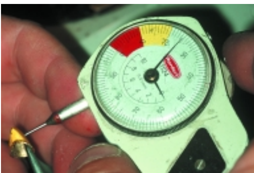
Abb. 15: 0,25 mm für Primär- und Sekundärteil – das ermöglicht ästhetische Arbeiten.
