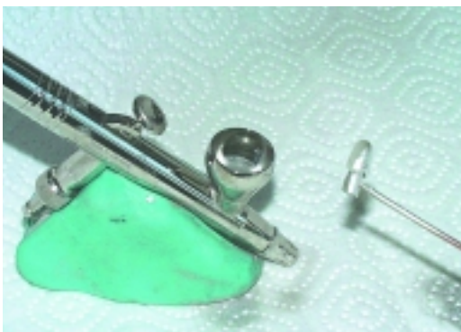
Abb. 11: Airbrushpistole mit besprühtem Innenteil.
