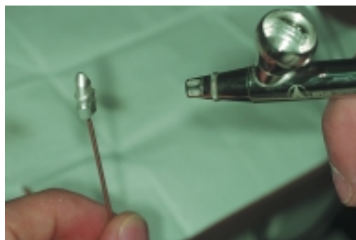
Abb. 12: Mit der Airbrushtechnik lässt sich Silberleitlack einfacher und gleichmäßiger auftragen.
