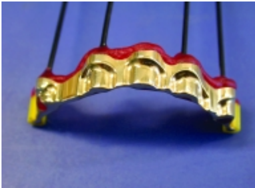
Abb. 9: Die Vorbereitung zum Galvanisieren: Drähte kontaktieren und mit Pattern Resin abdecken.
