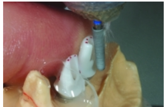
Abb. 14: Die Balance-Abutments werden auf dem Modell positioniert, im Fräsgerät ausgerichtet und materialgerecht unter Wasserkühlung beschliffen.
