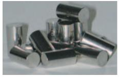
Die biokompatible, extra weiche NE-Aufbrennlegierung LOGO BOND E.W. ermöglicht preiswerte Kronen- und Brückenkonstruktionen.
