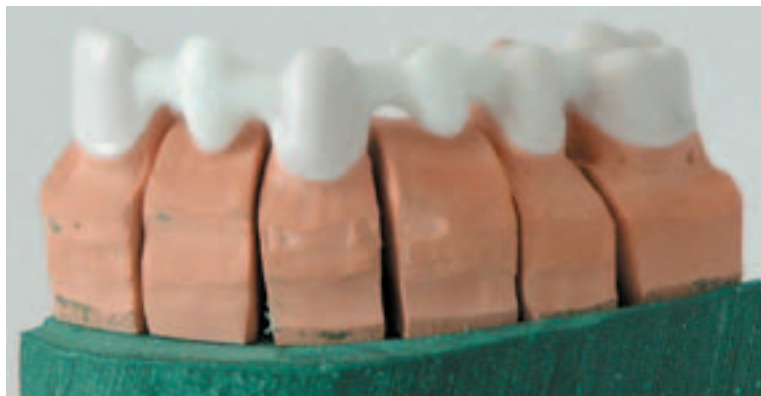
Abb. 2: Sechsgliedriges Brückengerüst aus yttriumstabilisiertem Zirkoniumdioxid (KaVo Everest® ZS).
