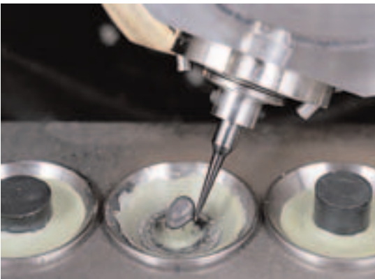
Abb. 6: CAM-Bearbeitung einer schwindungsfreien Zirkonkeramik (HPC-Blank) mit dem KaVo Everest® System.
