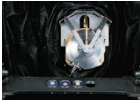
Abb. 5: Fünf-Achs-Fräsen einer Vollkrone mit Kaufläche aus Keramik.
