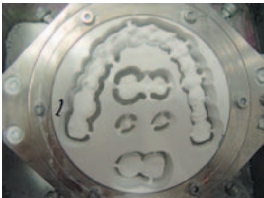
Abb. 14: In einem Stück gefräste xawex-Brücke (15 Glieder).
