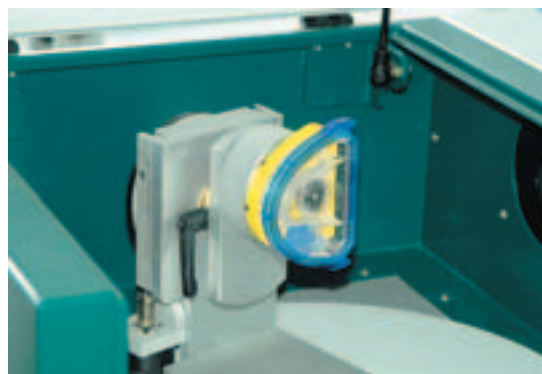
Abb. 5: Einzelstumpf-Scannung im model-tray-Sockler im LAVA Vollkeramiksystem von 3M ESPE.
