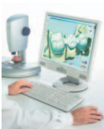
Abb. 2: Aus den Aufnahmen des inEos-Scanners von Sirona errechnet der Computer die dreidimensionale Darstellung von Einzelstümpfen, Brückensituationen und Ganzkiefermodellen. Der Zahntechniker konstruiert den Zahnersatz mit der bewährten CEREC inLab 3D-Software; die Herstellung erfolgt durch die inLab-Schleifeinheit.
