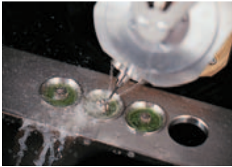
Abb. 4: Fünf-Achs-Fräsen einer Vollkrone mit Kaufläche aus Titan.
