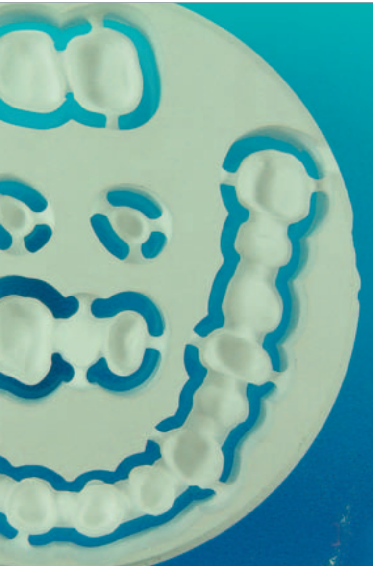
Titelmotiv: In einem Stück gefräste xawex-Brücke (15 Glieder). Mit freundlicher Genehmigung von ZTM Volker Scharl.
