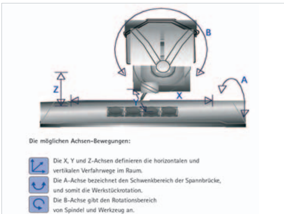
Abb. 3: Fünf simultan gesteuerte Achsbewegungen.
