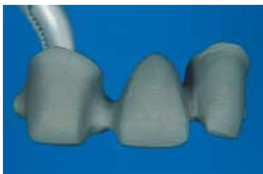
Abb. 31: Nach dem Oxidbrand – eine einwandfreie Legierungsoberfläche.
