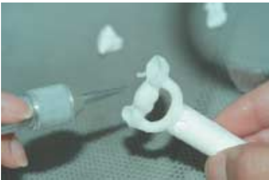
Abb. 5: Das Keramikgerüst wird mit 50 \mu bei 1,5 bis 2,0 bar abgestrahlt.
