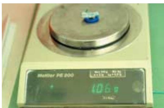
Abb. 3: Abwiegen des Wachsgerüsts zur Bestimmung der benötigten Pellets für die Pressung.
