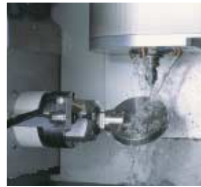
Eine 5-Achs-Fräsmaschine, die neben den Standardgerüsten ebenso Spezialitäten wie z. B. Implantat-Suprakonstruktionen produziert: Hint-ELs® hiCut5x
