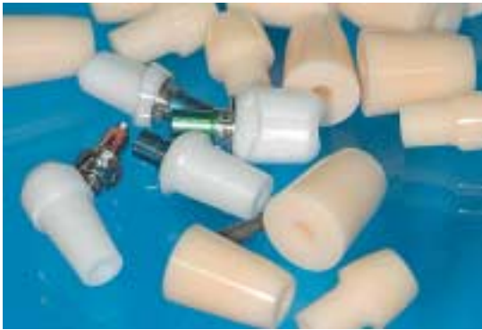
Abb. 1: Zirkonoxid ist wegen seiner hervorragend glatten Oberfläche der optimale Werkstoff für Implantatabbauten.
