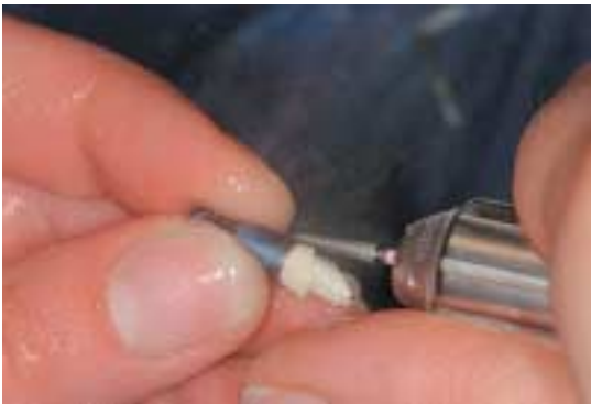
Abb. 13: Stets mit wassergekühlter Turbine: Nacharbeiten an gesintertem Zirkonoxid.
