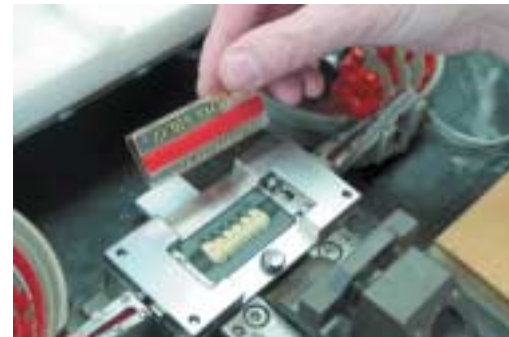
Abb. 6: Aufstecken der gebrannten Zähne auf die Garniturenblättchen.
