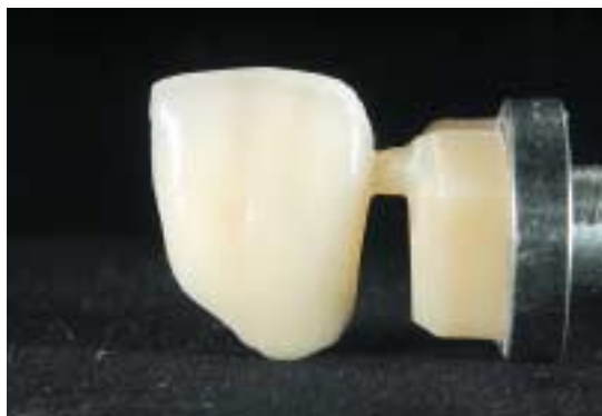
Abb. 8: Der Rohling nach dem Schleifprozess von labial ...
