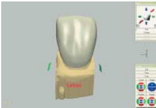
Abb. 5: Der Rohling wird von der Software virtuell auf den Stumpf aufgesetzt.
