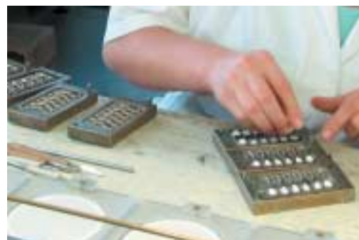
Abb. 3: Einlegen der Massen in die Zahnform.
