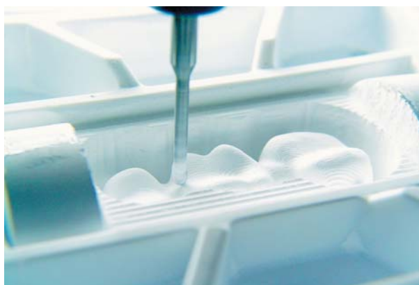
Abb. 1: Die Verarbeitung des ZrO_2 -Grünkörpers ist wirtschaftlich; die Fräszeit ist kurz, Werkzeuge werden geschont. (Foto: 3M ESPE)
