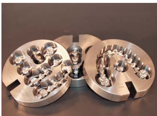
Abb. 10: Produktion von Metallgerüsten.
