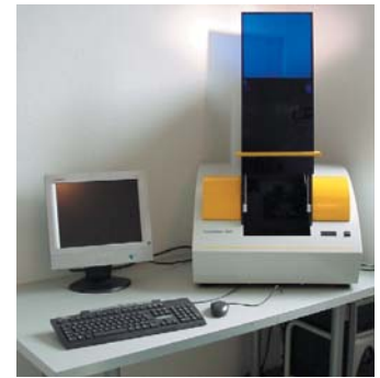
Abb. 2: Der optische 3D-Sensor SPEEDSCAN® scannt berührungsfrei und mittels Streifenlichtprojektion das Gipsmodell ein und schafft die Grundlage zur Erzeugung der dreidimensionalen CAD-Daten.
