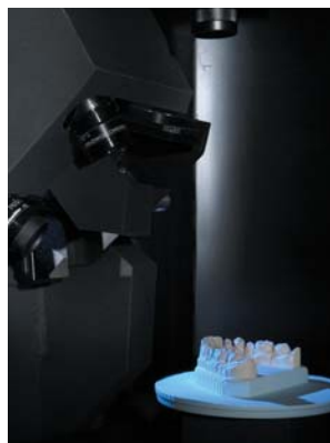
Abb. 3: Mehrere Kamerasysteme zur Kompletterfassung.
