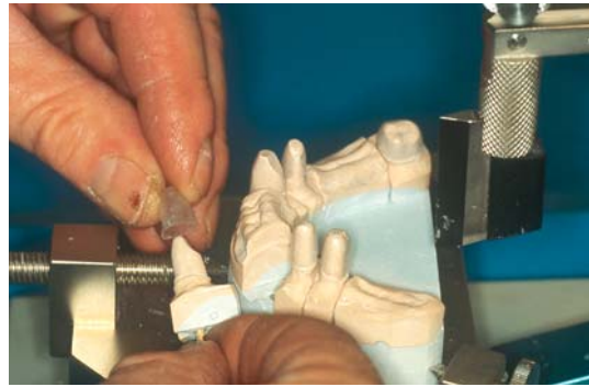
Abb. 6: ADAPTA Tiefziehkappe als bewährte Führungsschicht für das Schneiden in Wachs mit der Sicherheits-schichtstärke von 0,4 mm.
