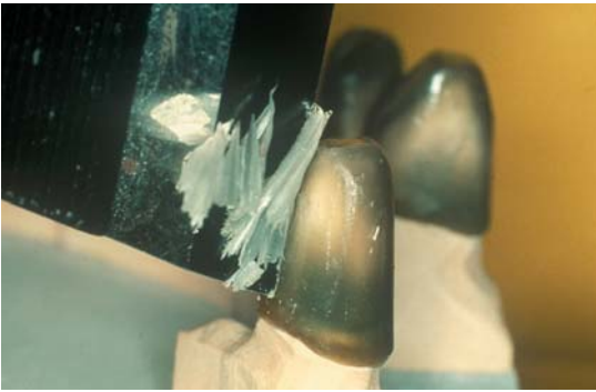
Abb. 5: Die Schneidetechnik: Durch Ziehen einer Schneide auf der Oberfläche des Wachsrohlinges unter Führung einer ADAPTA Tiefziehfolie ergibt sich eine Plane und extrem glatte Fläche unter der am Konometer eingestellten Winkelvorgabe.
