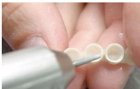
Minimaler Aufwand bei der Ausarbeitung eines Gerüstes aus zerion® mittels wassergekühlter Turbine.
