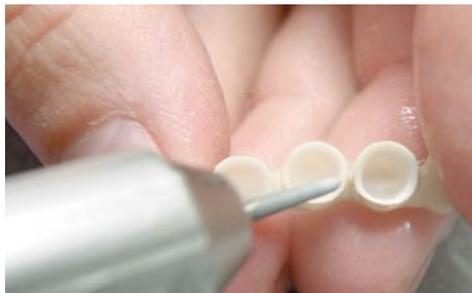
Minimaler Aufwand bei der Ausarbeitung eines Gerüstes aus zerion® mittels wassergekühlter Turbine.
